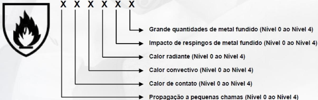
**0:** indica que a luva está abaixo do nível de desempenho mínimo para o risco.**X:** indica que a luva não foi submetida ao ensaio ou que o método de ensaio não é adequado para a luva ou para o material.
